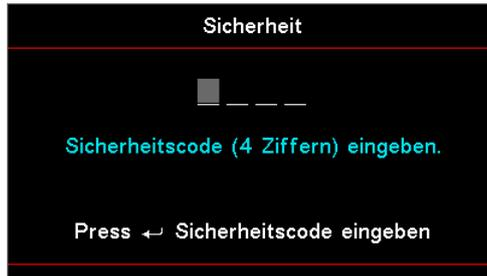
**Hinweis:** Falls das falsche Kennwort dreimal eingegeben wird, schaltet sich das Gerät nach 10 Sekunden automatisch aus.
