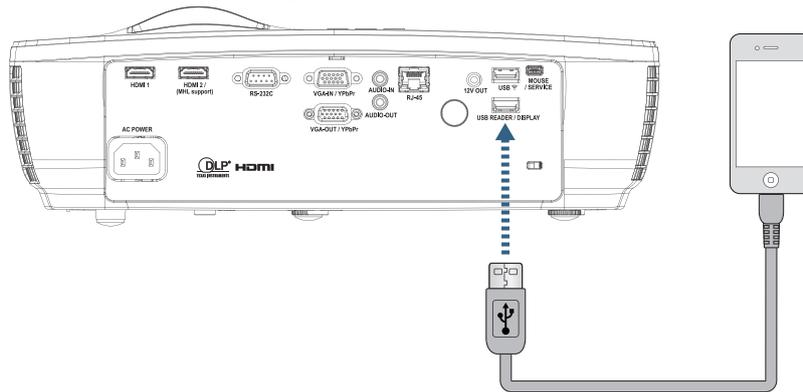
Öffnen Sie das Menü USB-Anzeige, indem Sie die Taste **Source** (Source) an Fernbedienung oder Bedienfeld drücken, und das Menü USB-Anzeige öffnet sich.
