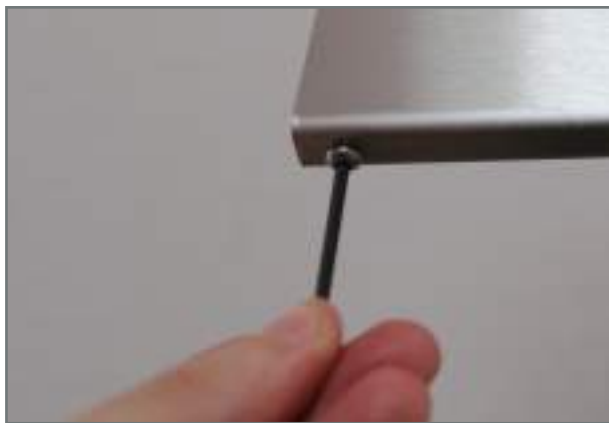
Abb. 5: Festschrauben der Sicherheitsschraube
